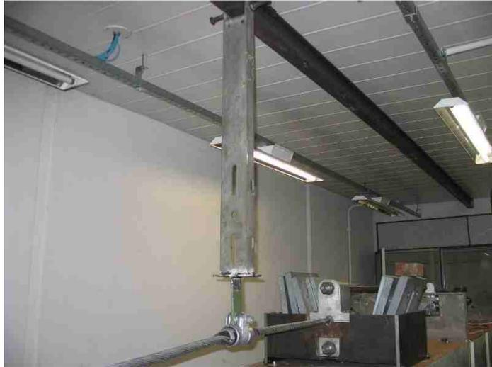
Figura 4 – Ancoragem vertical simulando isolador de suspensão
