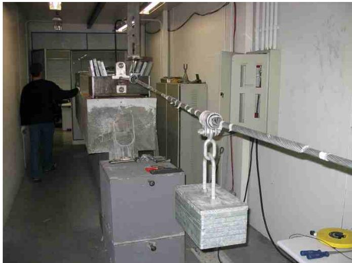
Figura 5 – Pesos adicionais instalados com grampo e alças
