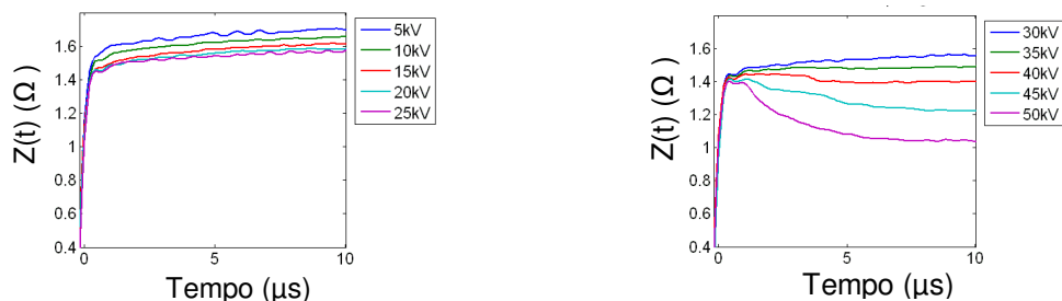
FIGURA 5 – Impedância transitória da amostra de solo Z(t) = v(t)/i(t) : Para cada amostra esta razão foi calculada para ondas de tensão e corrente (exemplo: solo I, 600 \Omega .m)
