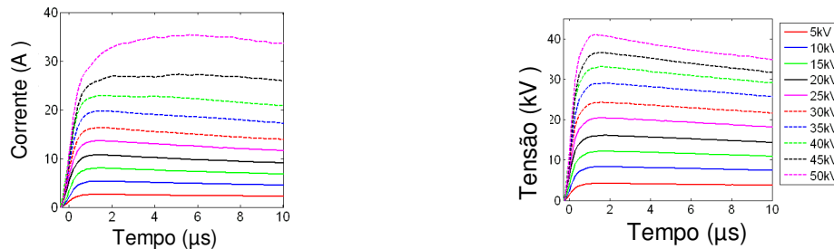
FIGURA 3 – Resultado primário típico: ondas de tensão impressas às amostras do solo entre as placas paralelas.
