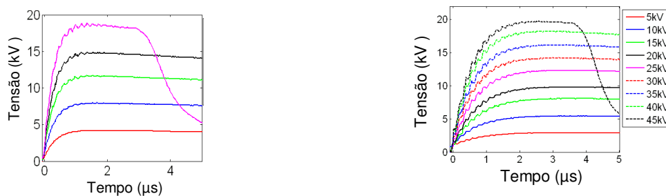
FIGURA 3 – Resultado primário típico: ondas de tensão impressas às amostras do solo entre as placas paralelas.
