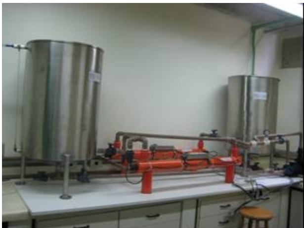
Figura 6. Unidade piloto de tratamento com radiação ultravioleta.
