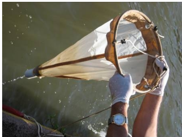
Figura 3. Rede de plâncton vista geral com malha de 30 \mu m.
