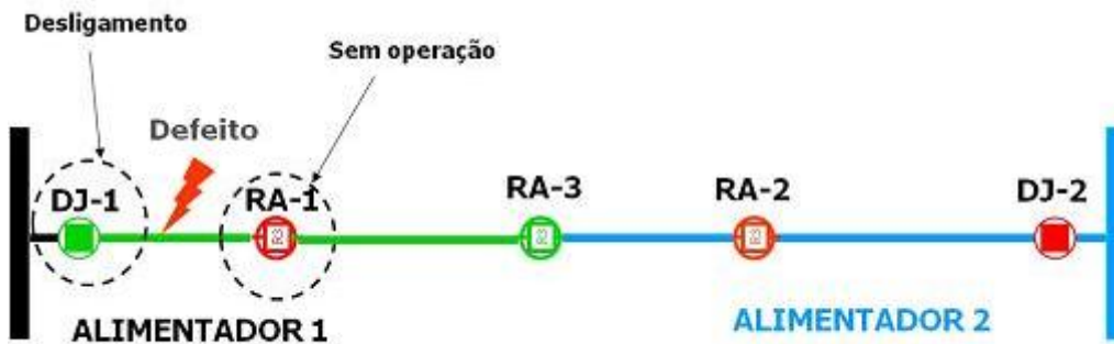
FIGURA 2 – Definição do trecho com defeito no alimentador.
