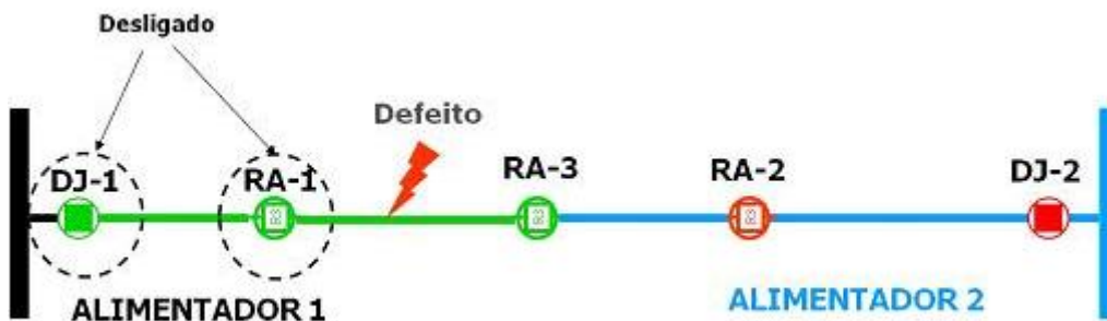
FIGURA 3 – Defeito à jusante do religador.
