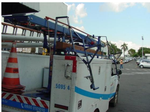
Figura 15. Sistema “basculador”- Instalação na lateral da caminhonete
