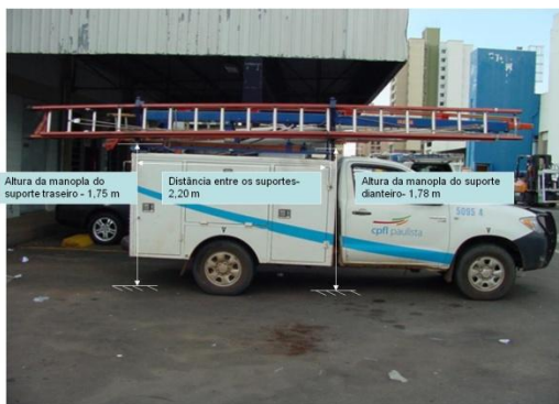
Figura 14. Sistema “basculador”- Instalação na lateral da caminhonete
