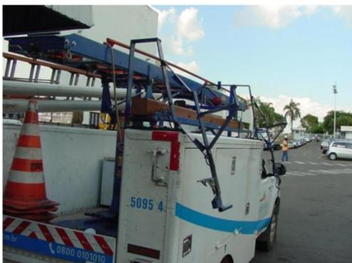
Figura 15. Sistema “basculador”- Instalação na lateral da caminhonete
