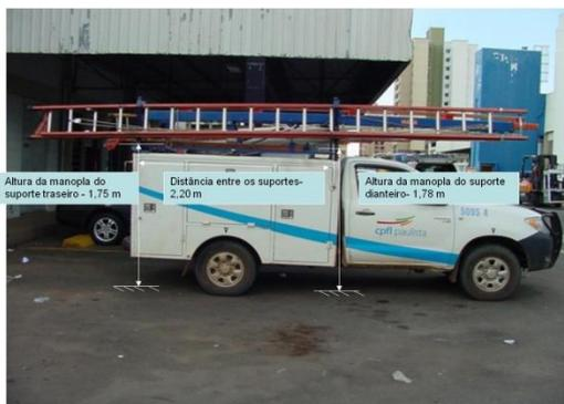
Figura 14. Sistema “basculador”- Instalação na lateral da caminhonete
