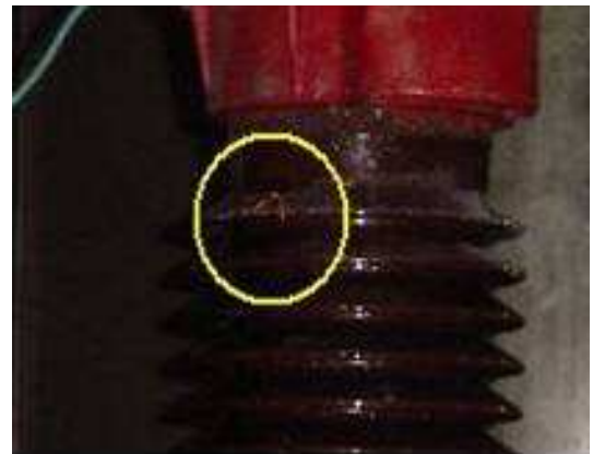
Figura 9 - Descarga superficial em pára-raios coberto com poluição salina.
