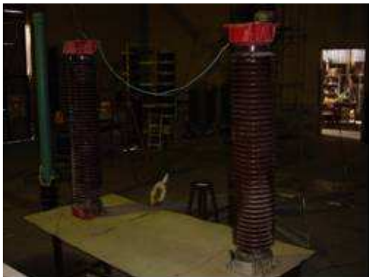
Figura 8 - Pára-raios cobertos por poluição salina.
