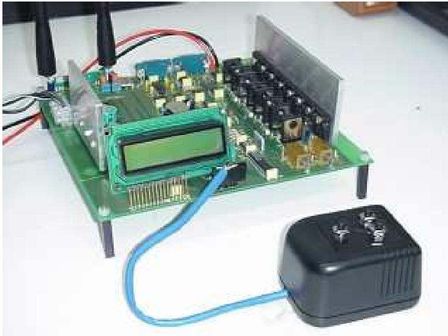
FIGURA 2: Protótipo do Equipamento de Medição (Unidade de Controle)
