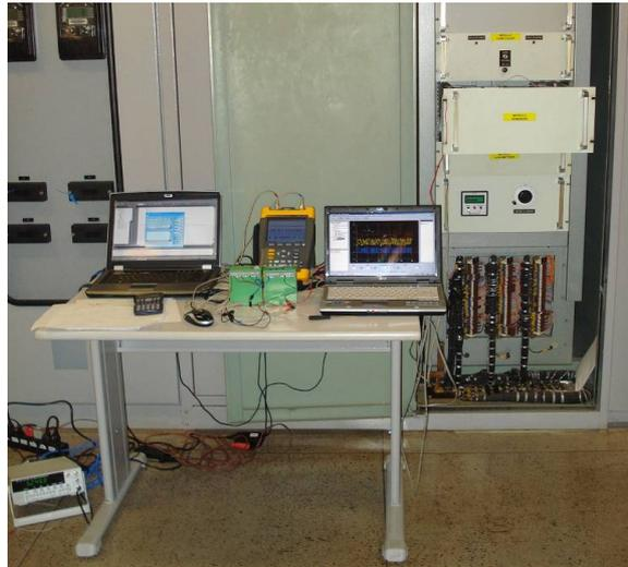
FIGURA 7 – Equipamentos montados ao lado do armário do RV da UGH 8.
