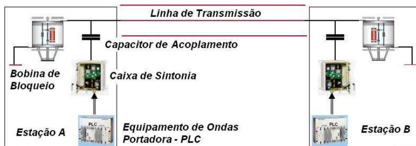
FIGURA 1 - Sistema de onda portadora – PLC(2).
