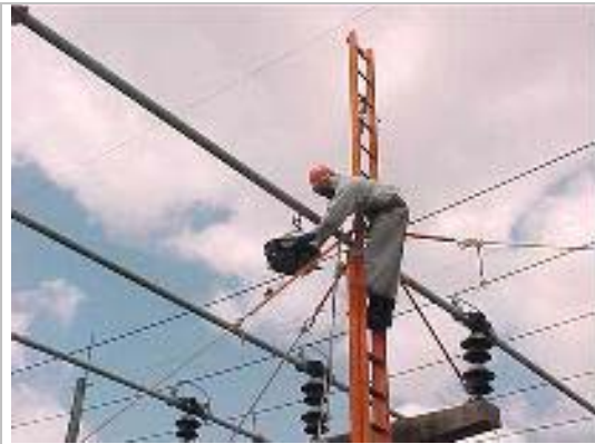
FIGURA 7 – Imagem do ensaio do robô sob o efeito do campo eletromagnético no barramento de SE na tensão de 69kV.
