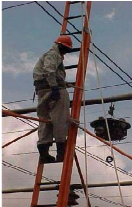
FIGURA 8 – Imagem do ensaio do robô sob o efeito do campo eletromagnético no barramento de SE na tensão de 230kV.
