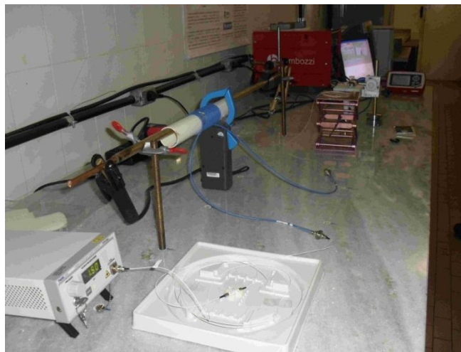
Figura 2. Sistema do sensor de altas correntes à fibra óptica.
