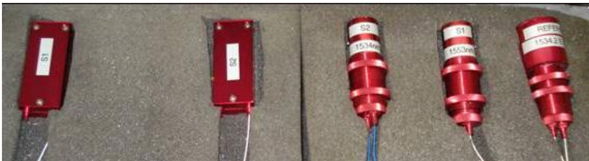
Figura 7. Protótipos dos sensores de proximidade.
