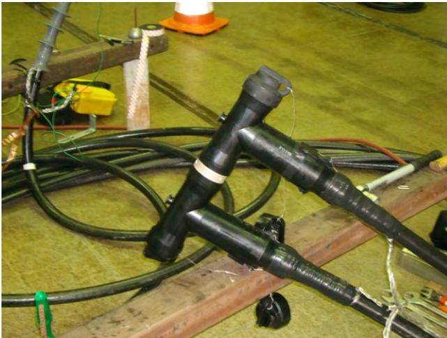
Figura 3. Emenda tipo desconectável formada por 2 TBB's (Terminal Básico Blindado).
