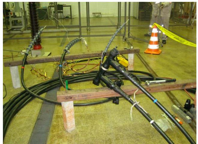
Figura 1. Esquema dos Três Cabos .Montados no Laboratório do IEE-USP.
