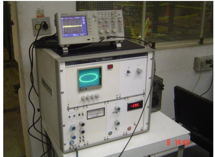
Figura 5. Sistema de Medição de Descargas Parciais.
