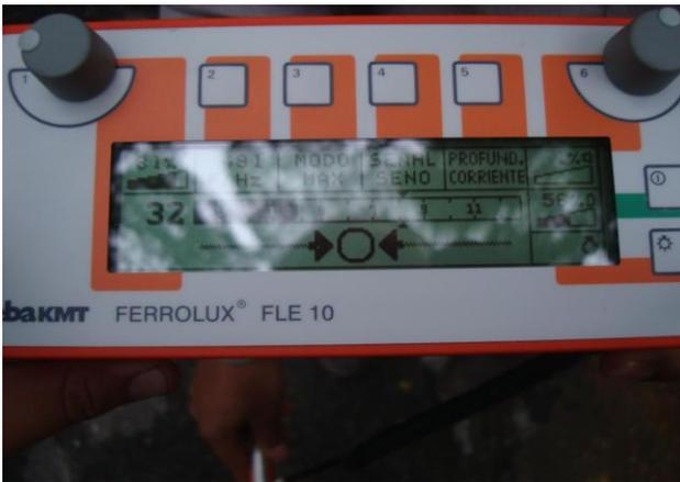
Figura 12. Detalhe do painel do receptor de áudio frequência.
