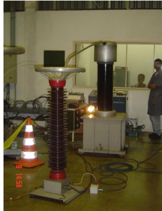
Figura 4. Sistema de Medição de Tangente Delta.
