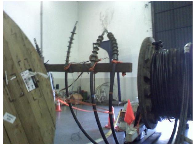
Figura 7. Detalhe dos terminais dos cabos.
