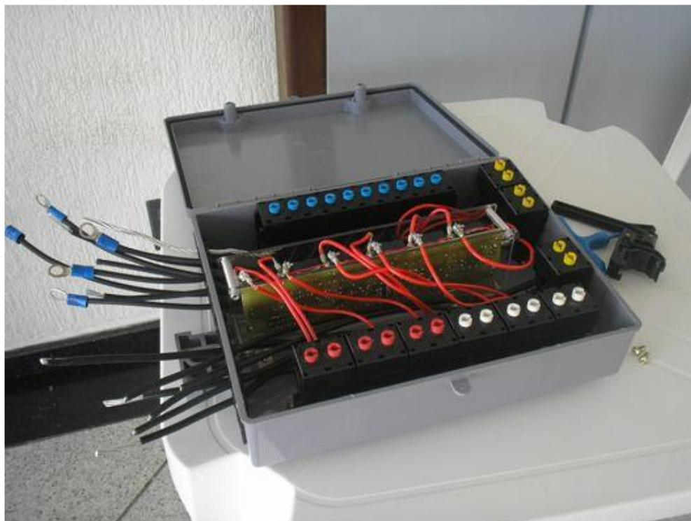
**Figura 4 – Caixa de distribuição da INCESA com o módulo atuador conectado às borneiras.**
