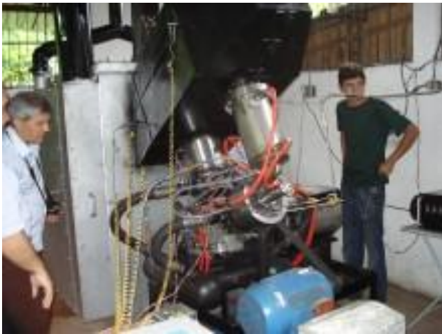
Fig. 15 – Motor Stirling em teste.
