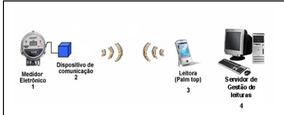
Figura 1. Arquitetura do Sistema de Leituras baseado na tecnologia Bluetooth.
