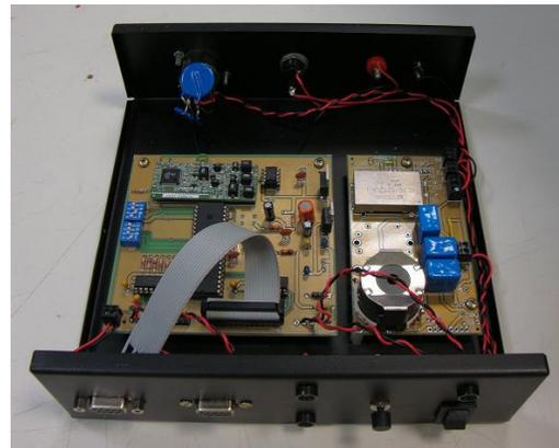
Figura 9. Modem PLC desenvolvido neste projeto.
