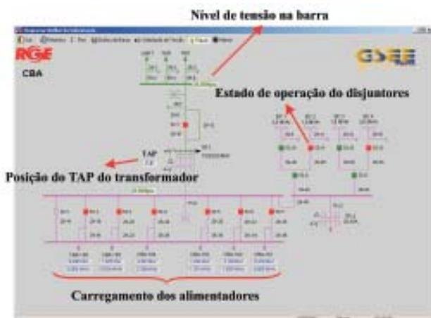
FIGURA 3: Tela de diagrama unifilar.
