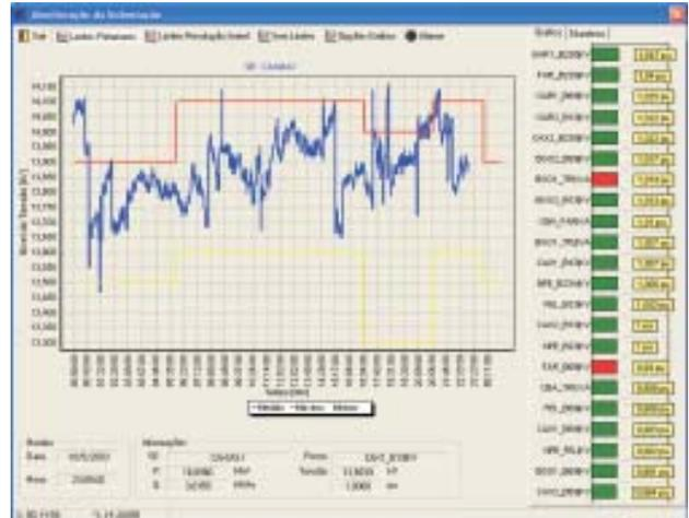
FIGURA 4: Monitoração de nível de tensão por subestação.
