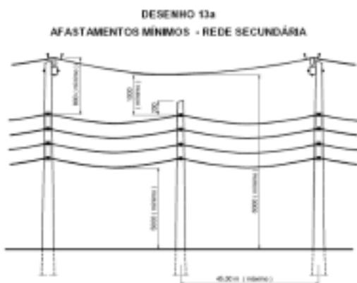
FIGURA 2 - Configuração típica de Linha de Distribuição.
