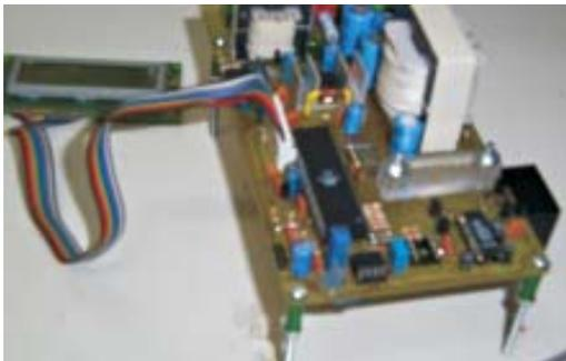
FIGURA 15 – Foto do controlador de carga.
