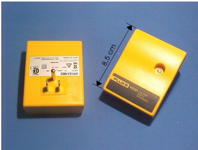
Figura 5 – Registrador de eventos de tensão
