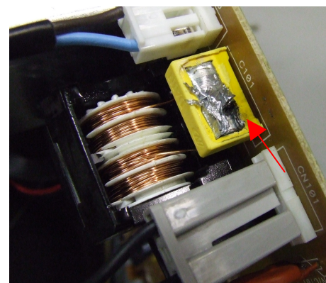
Figura 16 – Interior de uma TV danificada nos ensaios.
