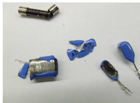
Figura 15 – Componentes danificados durante os ensaios
