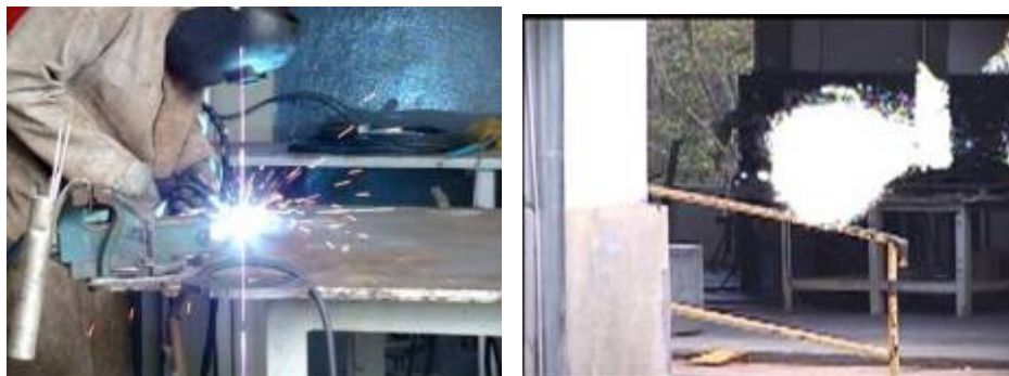
FIGURA 13 – Monitoramento da emissão de UV-C em soldas.
