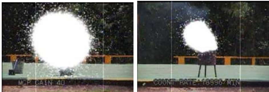
FIGURA 12 – Emissão de UV-C gerado por chama de GLP (esquerda) e querosene (direita).
