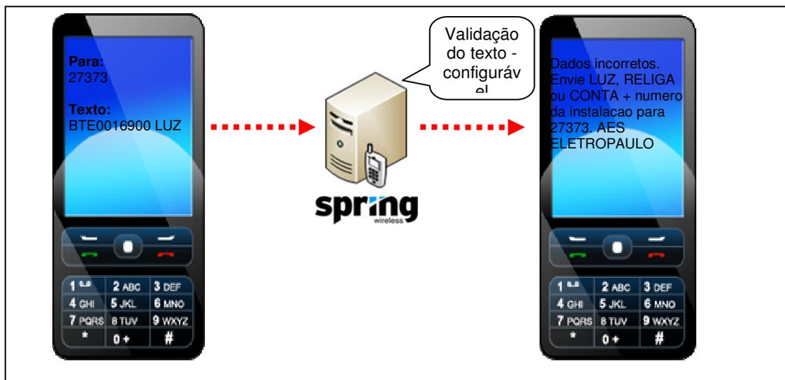
Figura 12 – Esquema de funcionamento do TORPEDO FÁCIL para Cenários não previstos.
