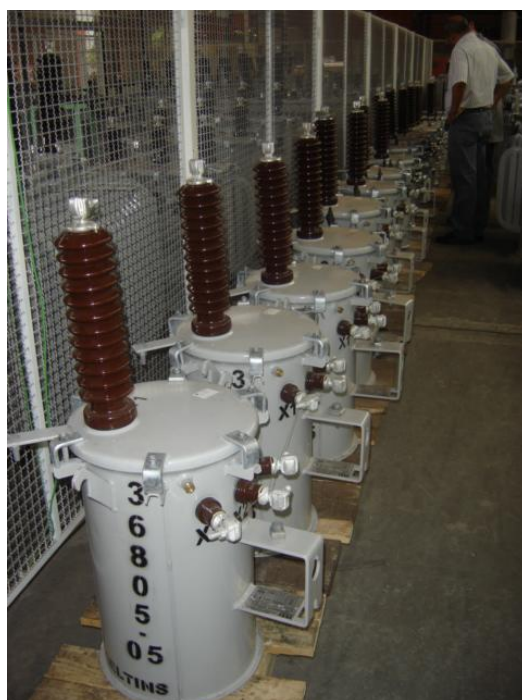
Figura 1. Transformadores MRT no ambiente da fábrica, antes da realização dos ensaios de rotina.
