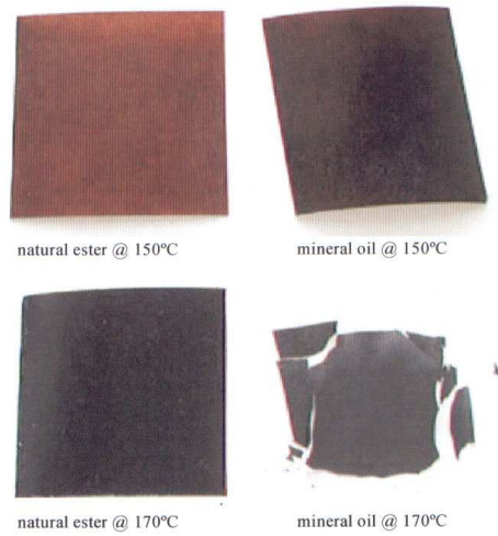
Figura 4. Papel Kraft termoestabilizado após 4000 horas.
