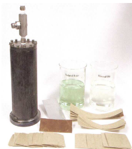
Figura 1. Componentes de um sistema de ensaio selado.
