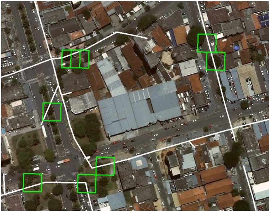
Figura 06 - Modelo de imagem com a representação da rede de MT e identificação dos pontos de interferência (polígonos verdes).
