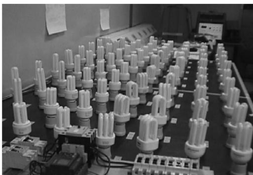
Figura 1 – Bancada para os ensaios (início dos testes)
