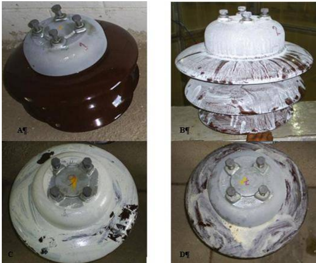
Figura 6 – Isoladores pedestal ensaiados com diversas coberturas: (A) Isolador novo; (B) Isolador com calda bordaleza; (C) Isolador com tinta epóxi; (D) Isolador com sulfato ferroso mais sylgard.
