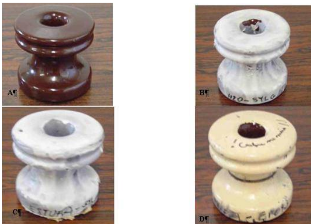
Figura 7 – Isoladores roldana ensaiados após 6 meses em diferentes envelhecimentos acelerados: (A) Isolador novo; (B) Isolador com Sylgard após imersão em água a 40 °C; (C) Isolador com Sylgard colocado em estufa; (D) Isolador com tinta epóxi colocado em estufa.
