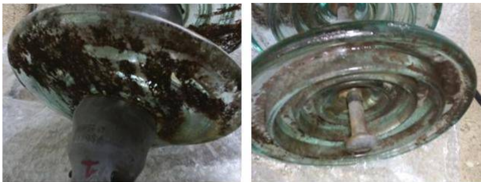
Figura 8 – Detalhe dos isoladores de disco com limo, enviados pela ELETRONORTE.
