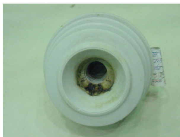
Figura 30 – Danos no isolador pino 4 ao fim do ensaio de compatibilidade dielétrica com cabo 5
