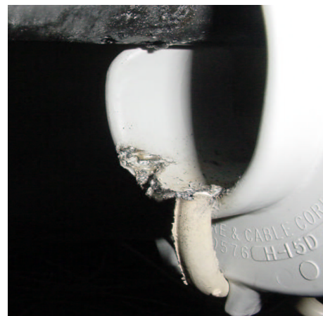
Figura 14 – Danos no espaçador 2 após ensaio de compatibilidade dielétrica com cabo 1
