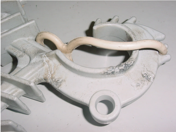
Figura 5 – Danos no espaçador 2 após 8 meses no campo
