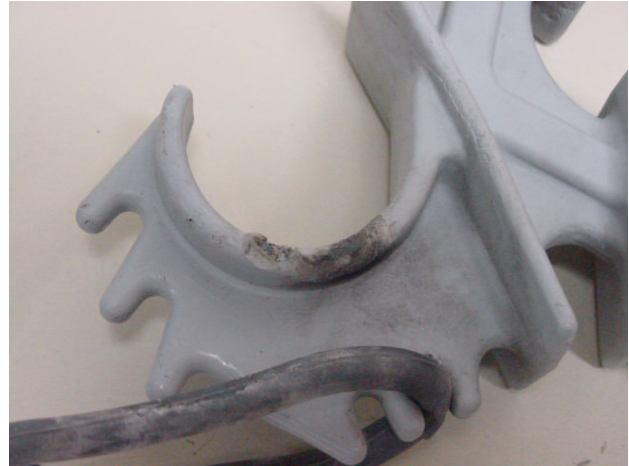
Figura 2 – Danos no espaçador 2 após 4 meses no campo
