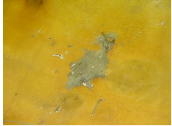
Figura 18 – Espaçador 3 derretido durante ensaio de compatibilidade dielétrica com cabo 4
