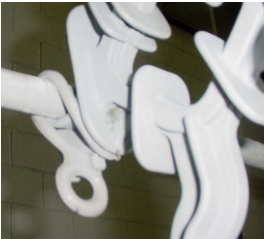
Figura 17 – Danos no espaçador 3 após ensaio de compatibilidade dielétrica com cabo 3
