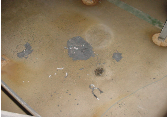
Figura 15 – Espaçador 1 derretido durante ensaio de compatibilidade dielétrica com cabo 2
