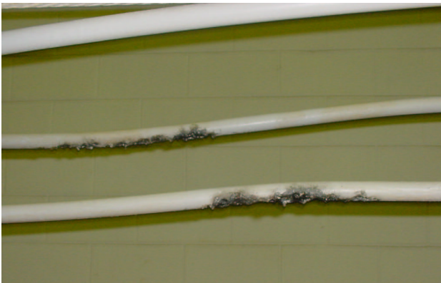
Figura 11 – Danos na cobertura do cabo 4 após ensaio de compatibilidade dielétrica
