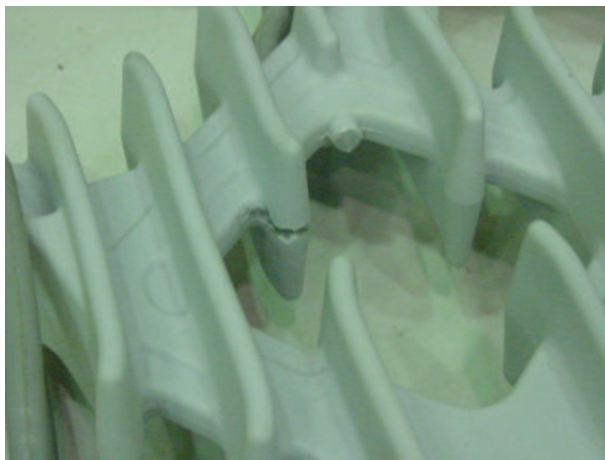
Figura 22 – Danos no espaçador 4 após ensaio de compatibilidade dielétrica com cabo 5
