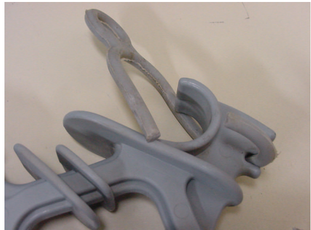
Figura 3 – Danos no espaçador 1 após 4 meses no campo
