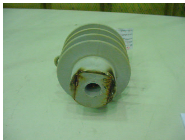
Figura 29 – Danos no isolador pino 1 ao fim do ensaio de compatibilidade dielétrica com cabo 5
