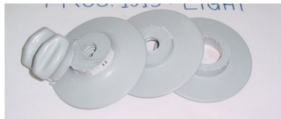
Figura 8 – Preparação de corpo-de-prova para ensaio de trilhamento
