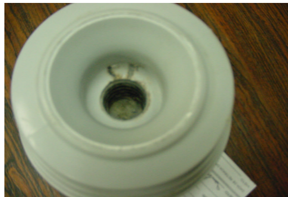
Figura 4 – Danos no isolador pino 2 após 4 meses no campo
