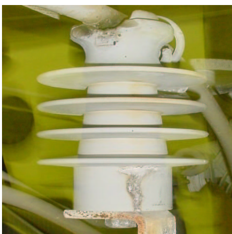
Figura 27 – Danos no isolador pino 1 ao fim do ensaio de compatibilidade dielétrica com cabo 4
