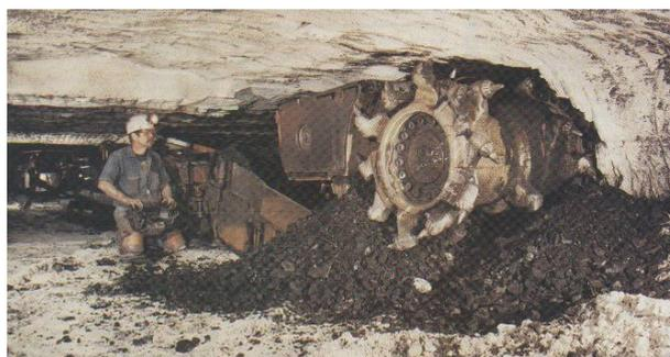
FIGURA 1 – Mineração contínua de carvão “Continuous Miner”
