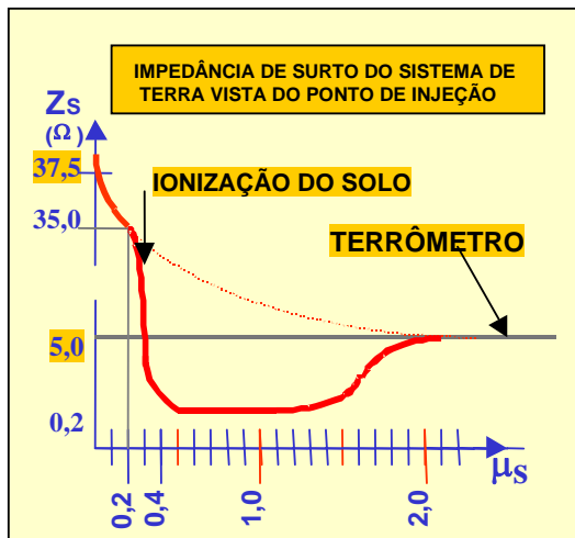
Figura 6 - Curva de variação da impedância de surto de uma malha de terra com o tempo, vista do ponto de injeção do surto. Chamada Impedância Dinâmica de Surto
