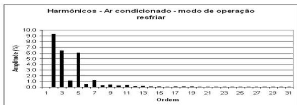
Figura 17 - Valores médios de harmônicos das amostras dos aparelhos de ar condicionado no modo de operação "resfriar"
