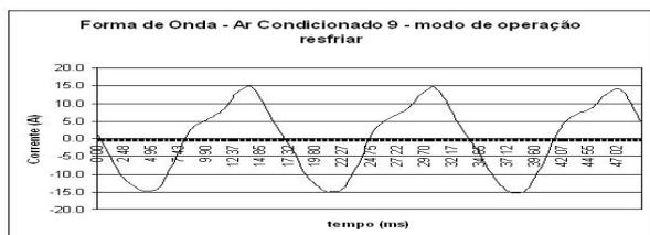
Figura 15 - Onda de corrente do aparelho de ar condicionado no modo de operação "resfriar"
