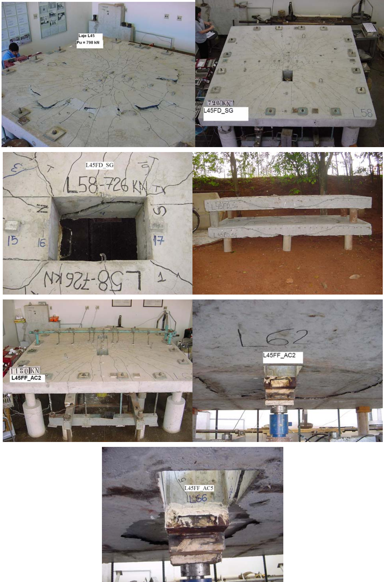
FIGURA 8 – Fotografias das configurações de ruínas de algumas lajes ensaiadas
