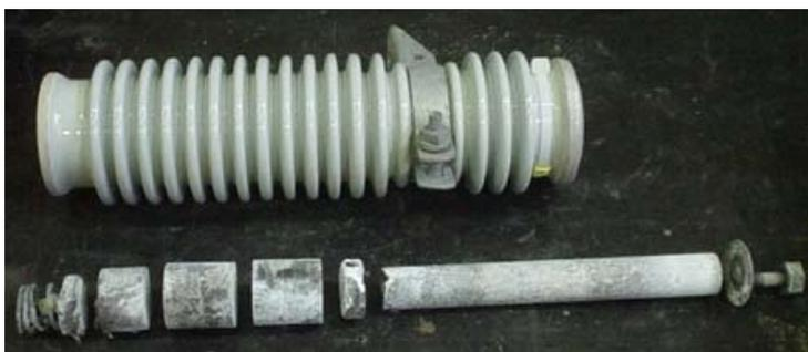
FIGURA 3c – PR 31187, componentes internos
