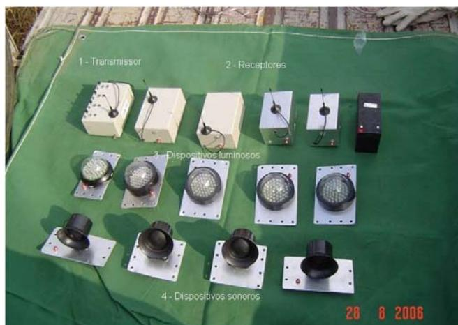
Figura 5 – Dispositivos do protótipo para testes em campo.
