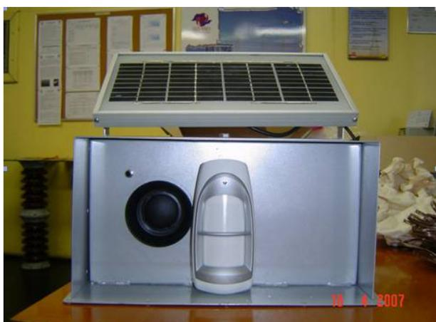
Figura 7 – Equipamento eletrônico repelente de pássaros.
