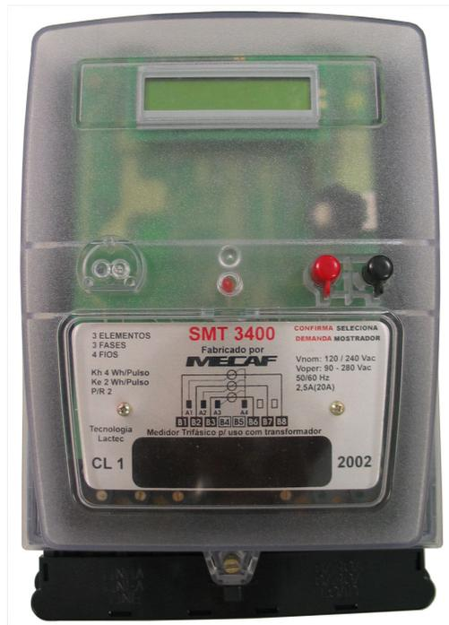
Figura 2 – Medidor eletrônico trifásico com módulo de comunicação PLC e relés integrados.
