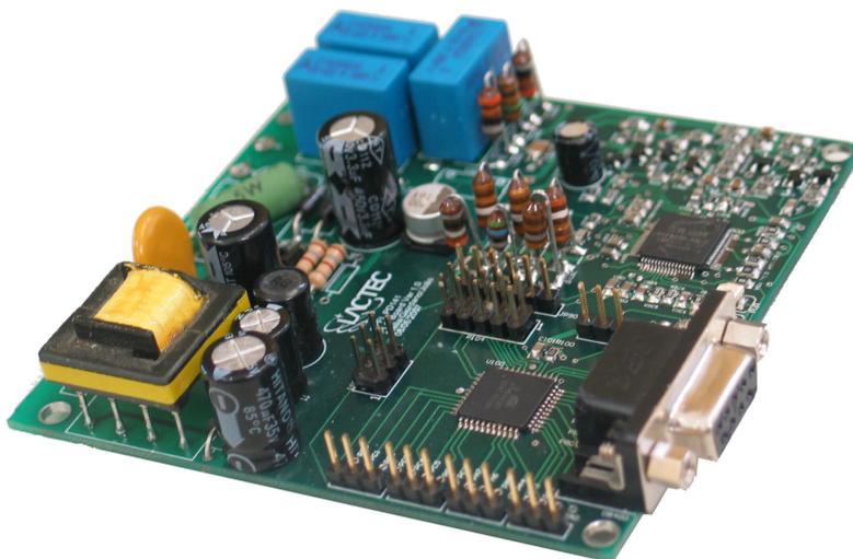
Figura 3 – Módulo de Comunicação PLC desenvolvido no projeto.
