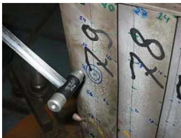
Figura 7. Análise modal experimental do grupo de 5 palhetas na condição engastada-livre.
