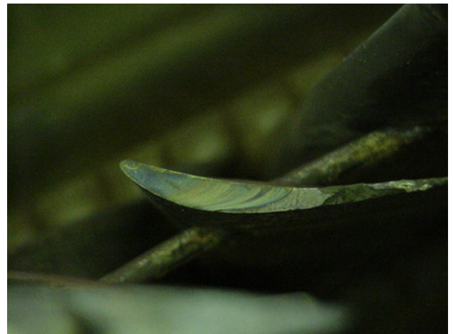
Figura 2. Beach marks na seção transversal da palheta quebrada.
