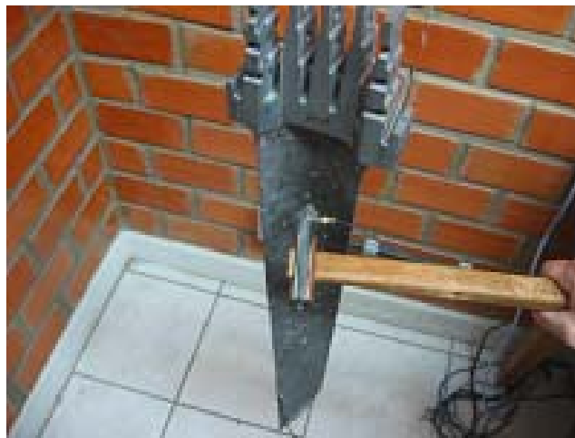
Figura 3. Análise modal experimental da palheta na condição livre-livre.
