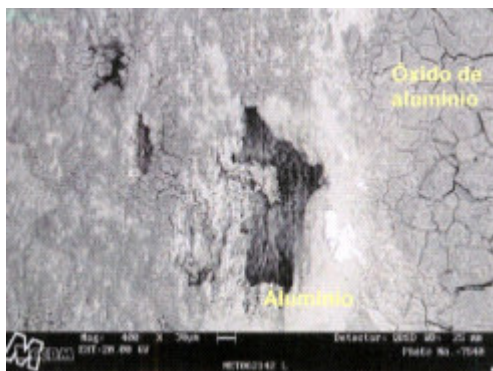
Fig. 12 –Alumínio 1350 CAA – pite e camada de óxido
