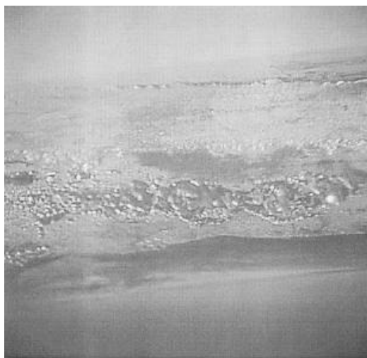
Fig.10 - Aspectos dos pites no condutor de alumínio com alma de aço.
