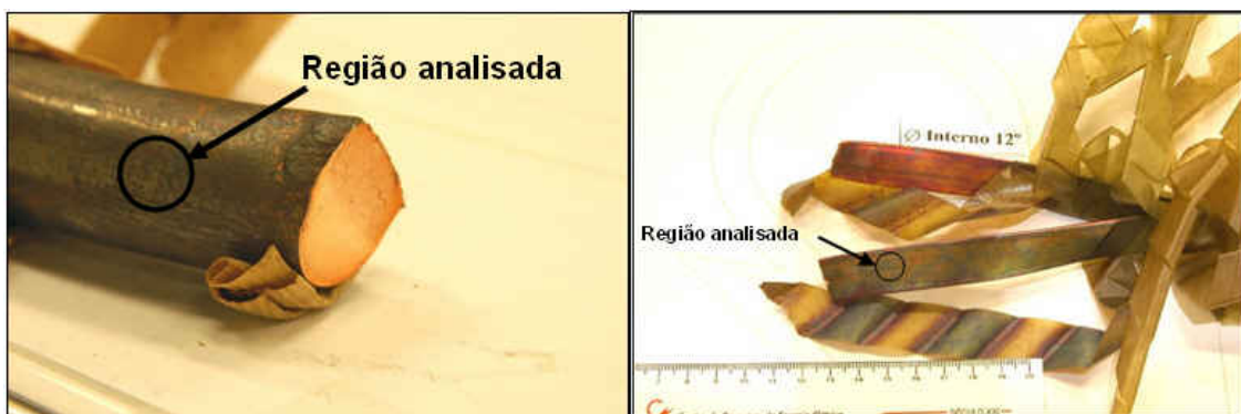
Figura 11 - Condutor cilíndrico de cobre (A) da bobina de regulação e condutor retangular de cobre da 12ª camada interna da bobina de AT do transformador
