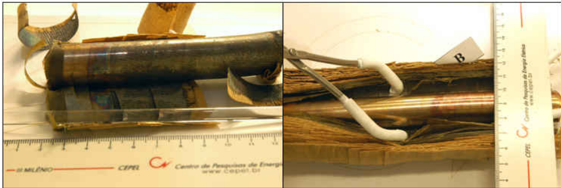
Figura 19 - Amostras de papel isolante crepado (A) e liso (B) dos condutores cilíndricos de cobre da bobina de regulação, para o ensaio de rigidez dielétrica
