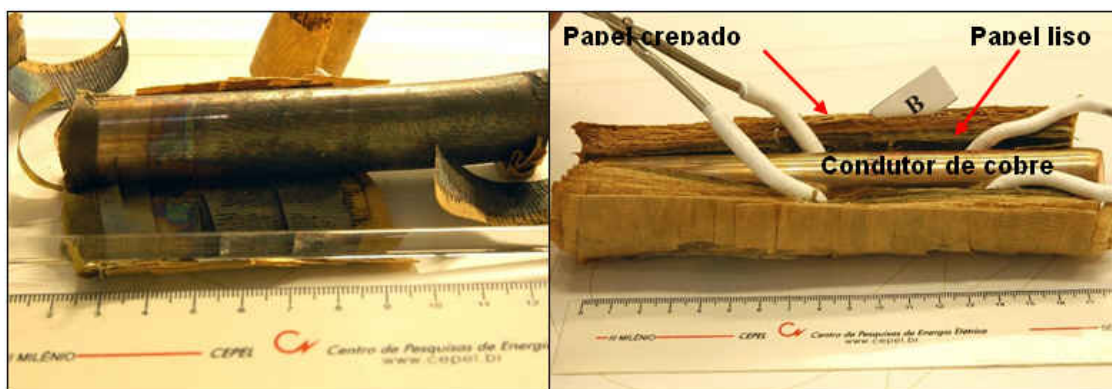
Figura 8 - Condutores cilíndricos de cobre (A) isolado em papel crepado e (B) com papéis isolantes liso e crepado da bobina de regulação do transformador de AT
