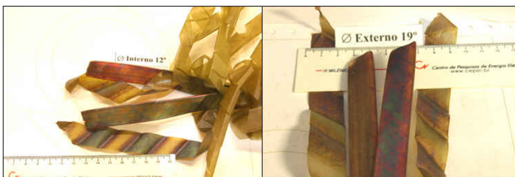
Figura 18 - Amostras de papel isolante liso da 1ª e 2ª camadas de condutores de cobre da bobina de AT, para o ensaio de rigidez dielétrica
