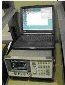
FIGURA 2. Analisador de espectro e PC para automação de medidas.
