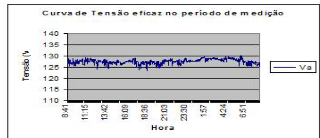
Figura 1. Valor eficaz de tensão em uma residência de 2 quartos
