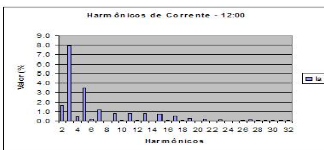
Figura 7. Espectro harmônico da Figura 5 em uma residência de 2 quartos
