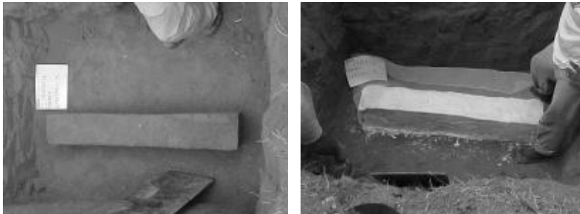
FIGURA 1- Amostras de solo sendo retiradas e recoberta com parafina ( foto Amostra3 - Cachoeira Paulista -01/08/02 )
