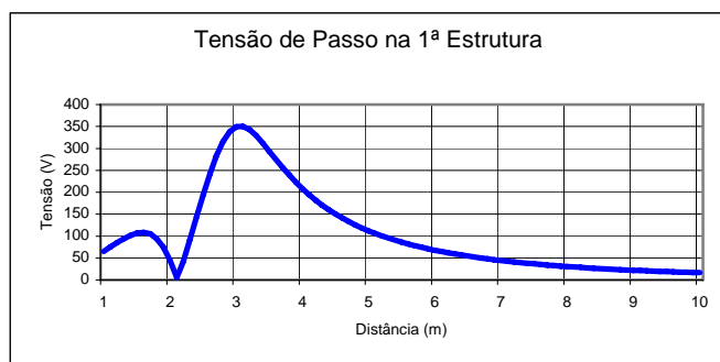
Figura 15 – Tensão de Passo na 1ª Estrutura Aterrada
