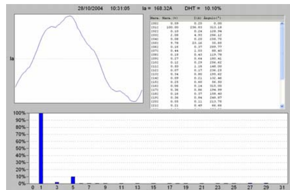
Figura 6: Forma de onda e espectro harmônico referentes ao Filtro de 5ª harmônica (TAP: “+4”) da redução IV, com todos os retificadores em operação normal, após da mitigação (fase A)
