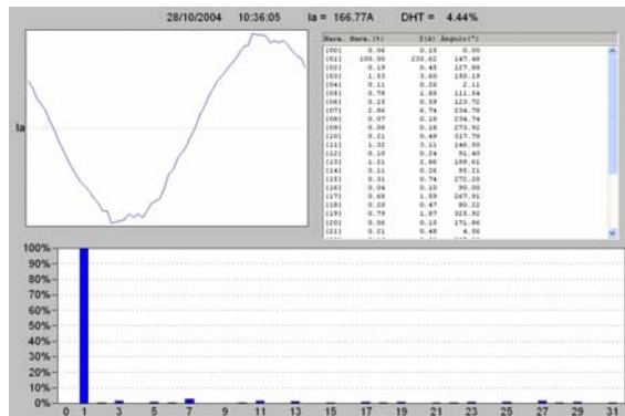
Figura 7: Forma de onda e espectro harmônico referentes ao Filtro de 7ª harmônica (TAP: “+6”) da redução IV, com todos os retificadores em operação normal, após da mitigação (fase A)
