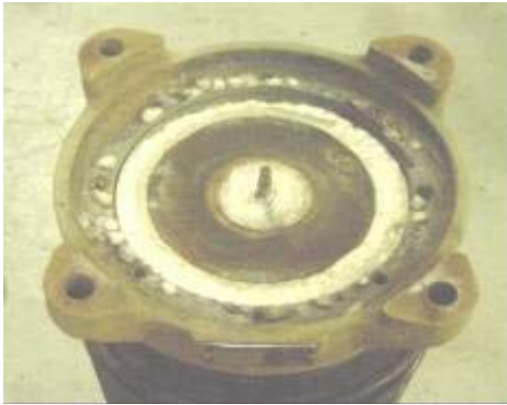
FIGURA 3 – Penetração de umidade em pára raios
