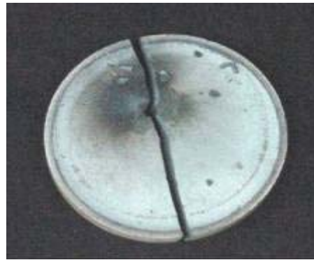
FIGURA 4 – Danos em blocos de carboneto de silício
