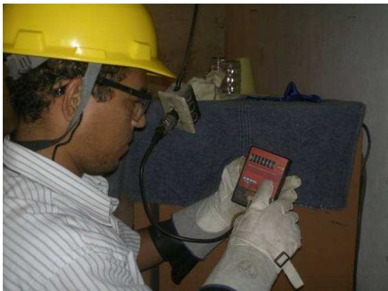
**Figura 16** – Medidor de energia elétrica portátil, analógico, com capacidade de medir continuamente energia e potência, tensão de alimentação de 90 a 280 V CA, frequência de 60 Hz, amperagem de 20 A CA; consumo interno de até 7 VA e precisão de 1%, conexão de entrada e saída via cabo com plugue e tomada universal de 3 pinos. Marca: KRON.
