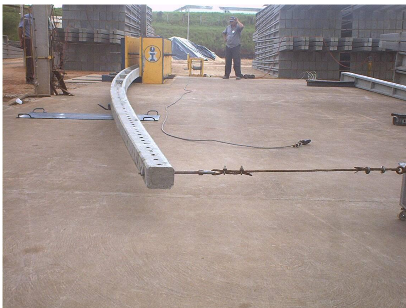
Figura 2 - Ensaio de resistência à ruptura em um poste de concreto. Ensaio realizado na face B.
