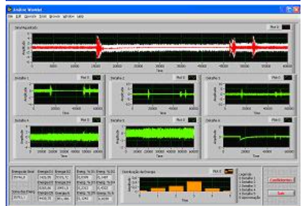
Figura 3 – Decomposição de um Sinal de Vibração Através da Transformada Wavelet
