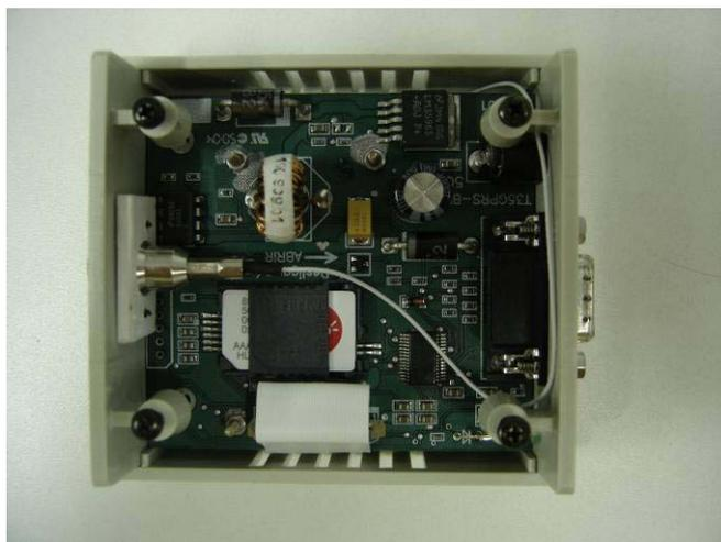
Fig. 3 – Módulo celular GSM.
