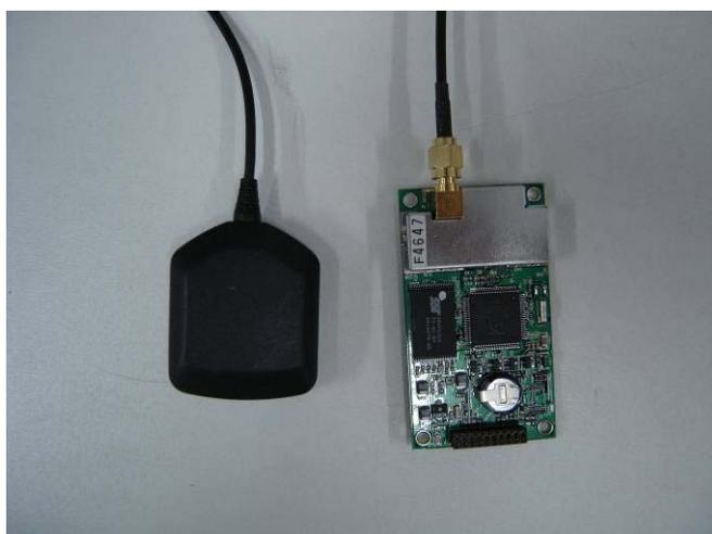
Fig. 4 – Antena e placa GPS.
