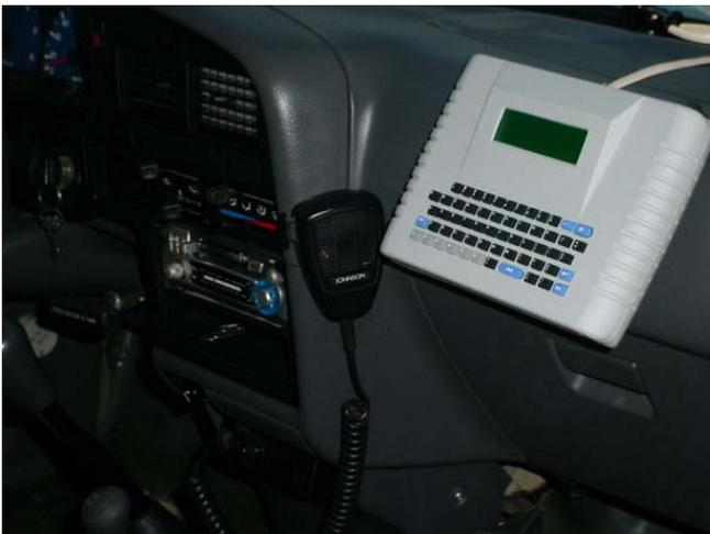
Fig. 8 – Terminal de comunicação embarcado em viatura de manutenção e emergência.
